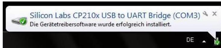
9. Unter „Arbeitsplatz – Systeminformationen anzeigen“ rufen Sie dann bitte den Gerätemanager auf. Im Gerätemanager öffnen Sie Gruppe „Anschlüsse (COM und LPT)“ und sehen dann den neuen, simulierten COM-Port „Silicon Labs CP210x USB to UART Bridge“. An diesem PC wurde automatisch der COM3 zugewiesen. Diesen COM-Port verwenden Sie dann zukünftig in Ihrem M-Bus Programm, um über den MR003 USB zu kommunizieren.
