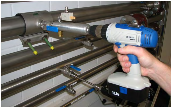
Bohren mit der CS Bohrvorrichtung Art.-Nr. 0530 1108
