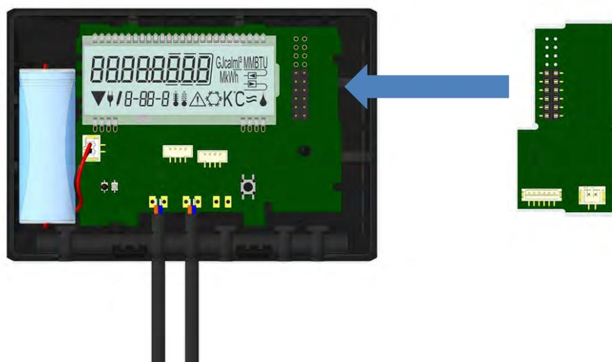
Zum Entfernen eines Moduls muss beim Aufklappen des Rechenwerks die Oberschale sorgfältig gegen die Rückwand der Unterschale gedrückt werden. Dabei heben die hinteren zwei Gehäuse-Verrastungen der Oberschale das Modul von der Platine los (siehe Bild 4).
