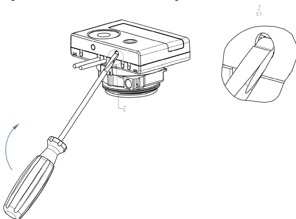
Das Schnittstellen-Modul ist rechts auf die Rechenwerk-Platine aufzustecken. Die Modul-Kabel werden durch die Kabeldurchführungen ganz rechts ins Rechenwerk geführt nach Entfernen der Blindtüllen. Rechenwerk schließen. Nach der Montage des Moduls muss der Zähler vom Monteur mit einer der den Modulen beigegebenen nummerierten Klebeplomben gegen Manipulation gesichert werden (über die zerstörte Plombe kleben). Der Barcode-Aufkleber kann für Dokumentationszwecke genutzt werden.
