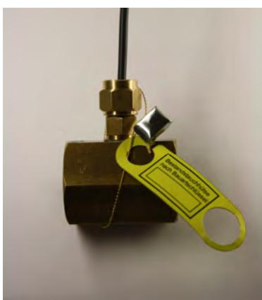
Beim Einbau der Temperatursensoren in Bestandstauchhülsen muss eine Tauchhülsenduldung vorliegen. In den folgenden Tabellen sind alle Tauchhülsen, für die eine Duldsung für Engelmann-Zähler vorliegt, aufgeführt. Alle anderen, hier nicht aufgeführten Tauchhülsen dürfen nicht bedient werden.
