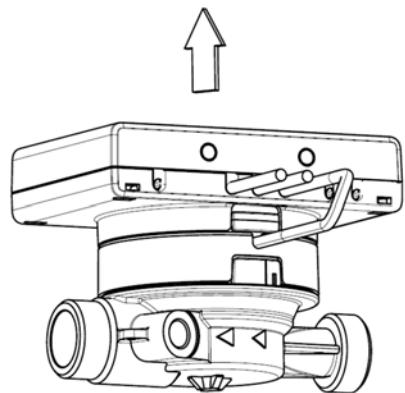
Es wird empfohlen, das Rechenwerk des Wärmezählers vom Durchflusssensor abzunehmen.
