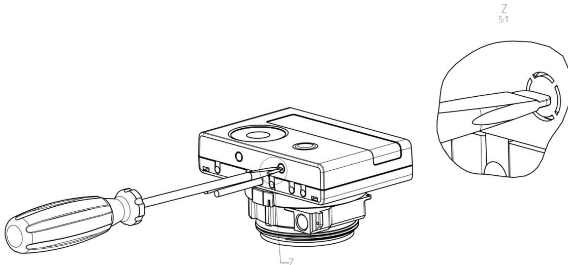
Danach den Schraubendreher in einem Winkel von ca. 45° in eine der beiden Öffnungen einführen und vorsichtig nach oben bewegen bis zu einem Winkel von ca. 90° (Bild 2). Die Oberschale des Rechenwerkes ist nun auf dieser Seite nicht mehr eingerastet. Dann dasselbe in der anderen Öffnung durchführen und Oberschale abnehmen.
