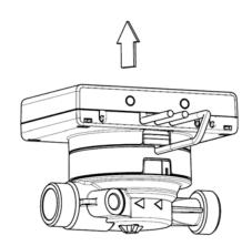
Es wird empfohlen, das Rechenwerk des Wärmezählers vom Durchflusssensor abzunehmen.
