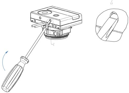
Das Schnittstellen-Modul ist rechts auf die Rechenwerk-Platine aufzustecken. Die Modul-Kabel werden durch die Kabeldurchführungen ganz rechts ins Rechenwerk geführt nach Entfernen der Blindtüllen. Rechenwerk schließen. Nach der Montage des Moduls muss der Zähler vom Monteur mit einer der den Modulen beigegebenen nummerierten Klebeplomben gegen Manipulation gesichert werden (über die zerstörte Plombe kleben). Der Barcode-Aufkleber kann für Dokumentationszwecke genutzt werden.
