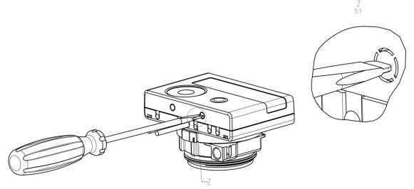
Danach den Schraubendreher in einem Winkel von ca. 45° in eine der beiden Öffnungen einführen und vorsichtig nach oben bewegen bis zu einem Winkel von ca. 90° (Bild 2). Die Oberschale des Rechenwerkes ist nun auf dieser Seite nicht mehr eingerastet. Dann dasselbe in der anderen Öffnung durchführen und Oberschale abnehmen.
