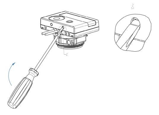
Das Schnittstellen-Modul ist rechts auf die Rechenwerk-Platine aufzustecken (siehe Bild 3). Die Modul-Kabel werden durch die Kabeldurchführungen ganz rechts ins Rechenwerk geführt nach Entfernen der Blindtüllen. Rechenwerk schließen.
