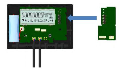
Zum Entfernen eines Moduls muss beim Aufklappen des Rechenwerks die Oberschale sorgfältig gegen die Rückwand der Unterschale gedrückt werden. Dabei hebeln die hinteren zwei Gehäuse-Verrastungen der Oberschale das Modul von der Platine los (siehe Bild 4).
