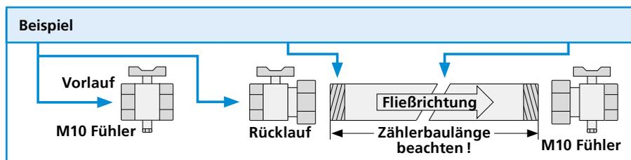
**Bitte beachten:** Gemäß MID 2004/22/EG ist seit 2016 bei Sanierung und Neueinbau eines Zählers bis  $q_p$  6 m<sup>3</sup>/h der Temperaturfühler direkttauchend einzubauen, wenn der Zähler für die Kostenabrechnung relevant ist.
