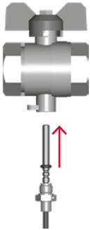
Seit 2016 müssen Temperaturfühler für Messgeräte thermischer Energie (Kälte- und Wärmehähler) bis  $q_p$  6 m<sup>3</sup>/h bei Neuinstallation (Neubau oder Anlagensanierung) direkteintauchend eingebaut werden (MID-Richtlinie EN 1434 und technische Richtlinie PTB K8). Bestehende Tauchhülsen haben Bestandschutz.
