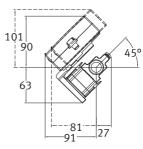
Mit Winkelbeschlag 3026-252 am Durchflusssensor montiert
