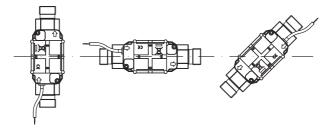
ULTRAFLOW® 24 darf waagerecht, senkrecht oder schräg montiert werden.
