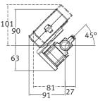
Mit Winkelbeschlag 3026-252 am Durchflusssensor montiert
