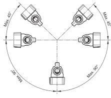
Wichtig! ULTRAFLOW® 24 darf bis zu ±45° zur Rohrachse nach oben und bis zu 90° zur Rohrachse nach unten gedreht werden.
