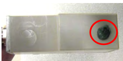
Abbildung 3 Aufbringen des akustischen Koppel Gels (Magnalube)
