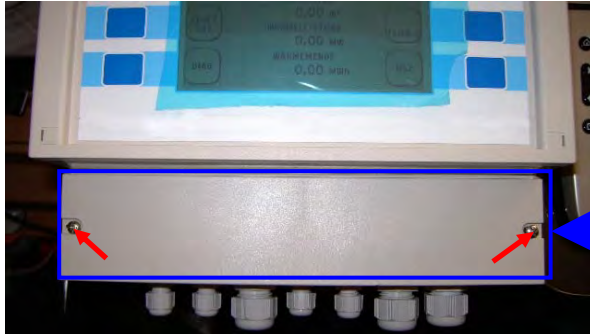
Abbildung 6 Öffnen des Zugangs zum Kabelraum
