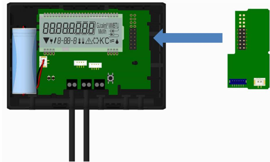
Zum Entfernen eines Moduls muss beim Aufklappen des Rechenwerks die Oberschale sorgfältig gegen die Rückwand der Unterschale gedrückt werden. Dabei hebeln die hinteren zwei Gehäuse-Verrastungen der Oberschale das Modul von der Platine los (siehe Bild 4).
