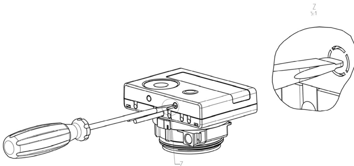
Danach den Schraubendreher in einem Winkel von ca. 45° in eine der beiden Öffnungen einführen und vorsichtig nach oben bewegen bis zu einem Winkel von ca. 90° (siehe Bild 2). Die Oberschale des Rechenwerks ist nun auf dieser Seite nicht mehr eingerastet. Anschließend dasselbe in der anderen Öffnung durchführen, dann kann die Oberschale abgenommen werden.
