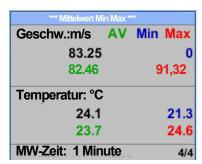
Die MW-Zeit (Zeitraum der Mittelwertbildung) kann über Sensor Einst.- Erweitert – MW-Zeit geändert werden.
