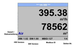
Das Umschalten auf die Seiten 2-4 erfolgt mittels Taste "  $\Delta$ "
