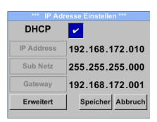
Hier kann eine Verbindung, mit oder ohne DHCP, zu einem Rechner eingerichtet und hergestellt werden.
