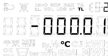
Abb. 21- Einstellung eines negativen TL2 in der "SETUP loop": Das - blinkt, wenn es auf der Vorzeichenstelle steht und bleibt eingeschaltet, wenn auf eine andere Ziffer gewechselt wird.
