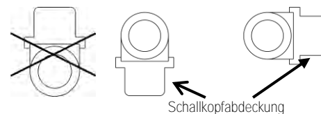
Abb. 6: Empfohlene Einbaulage bei Kältezählung
