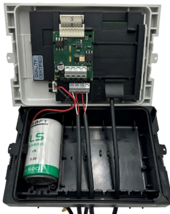
Figure 3 Im Messgerät installiertes Modul
