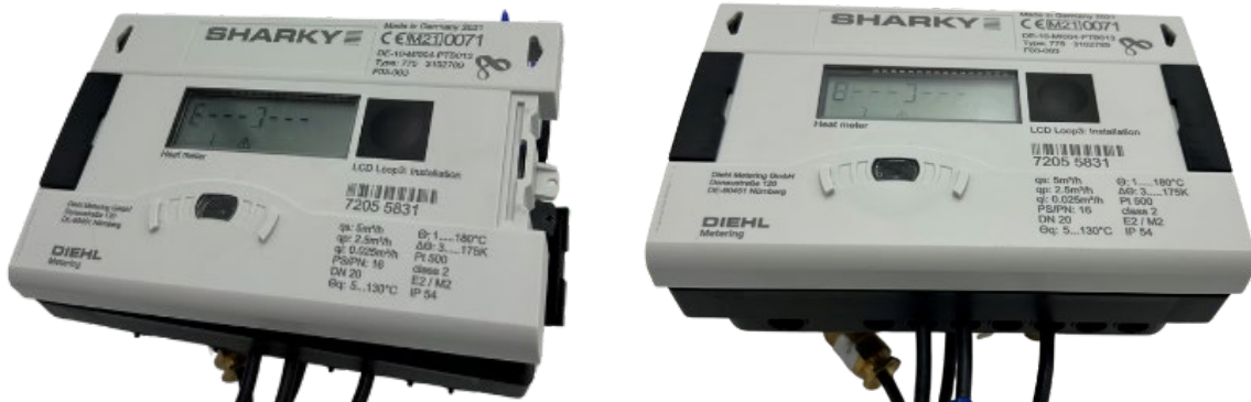
Figure 8 Schließen des Zählergehäuses von links beginnend, dann Schließen des Zählergehäuses mit den seitlichen Riegeln
