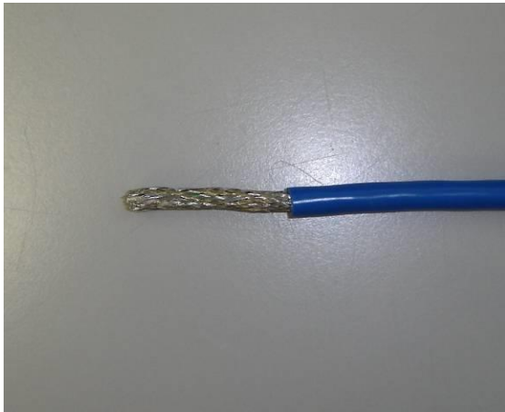
1: Den Mantel auf eine Länge von 35 mm entfernen
