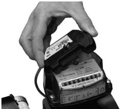
2) Screwing (Max torque: 0,25Nm)
